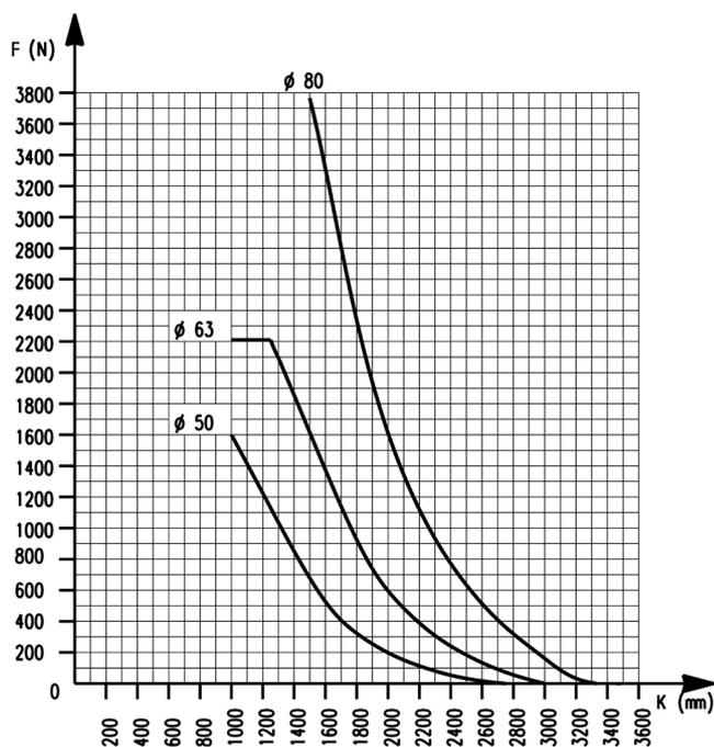
Примечание: Графики показывают максимально допустимые нагрузки для опоры на две точки. При этом прогиб не превышает 0,5 мм. Если действующая нагрузка превышает приведенные значения, то следует вводить дополнительную опору Мод. ВН-50.
